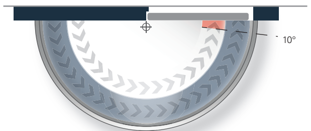
Schließkraftdiagramm ECO Newton TS-14 EN, Bandseite
