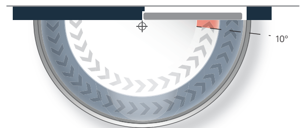
Schließkraftdiagramm ECO Newton TS-14 EN, Bandseite
