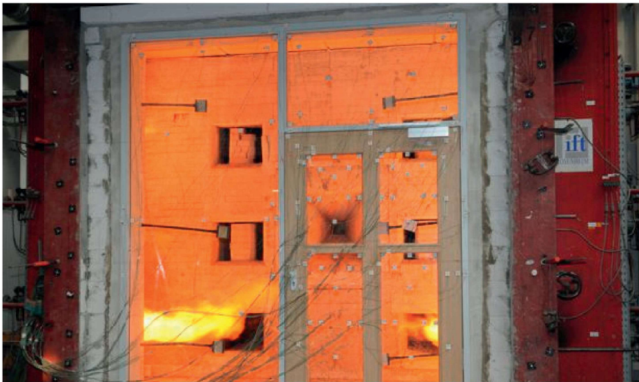
Abb. 1: Start einer Brandschutzprüfung im ift Rosenheim
